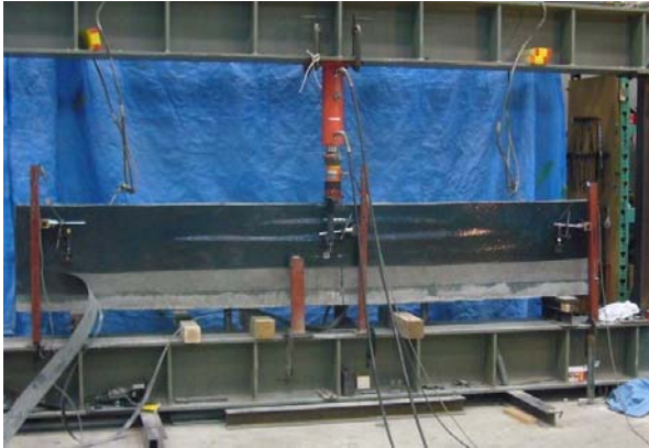
写真一三 炭素繊維補強した無筋梁の実験
