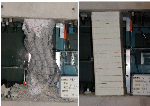
写真一 2 RC 柱 (左) の崩壊と SRF 柱
