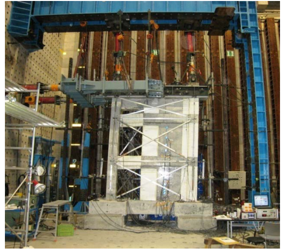
写真一六 偏在開口連層壁繰返し載荷実験 8)
