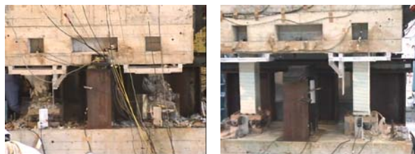
写真一八 RC 建物模型の倒壊とその時点の SRF 模型
