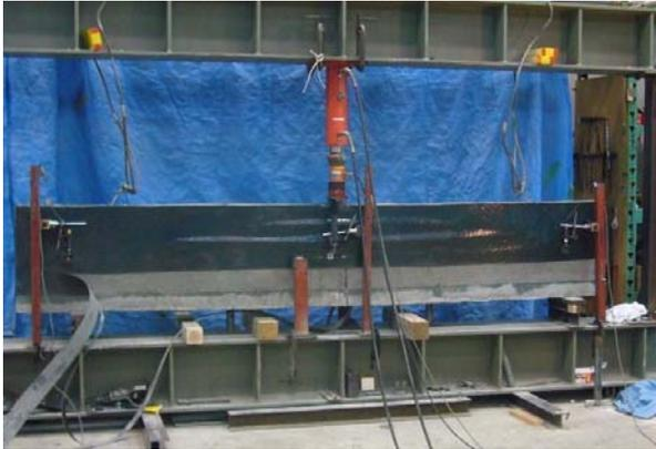
写真一三 炭素繊維補強した無筋梁の実験
