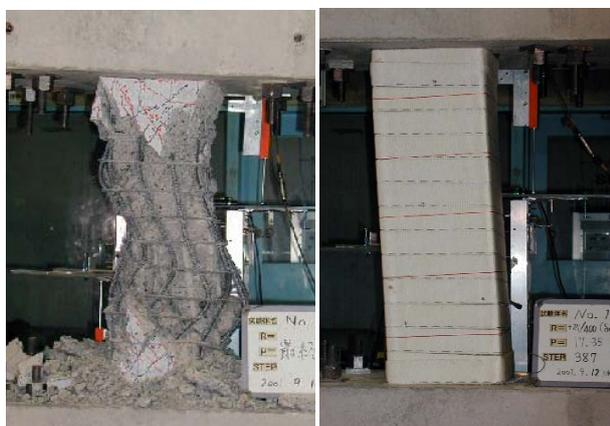
写真一 2 RC 柱 (左) の崩壊と SRF 柱
