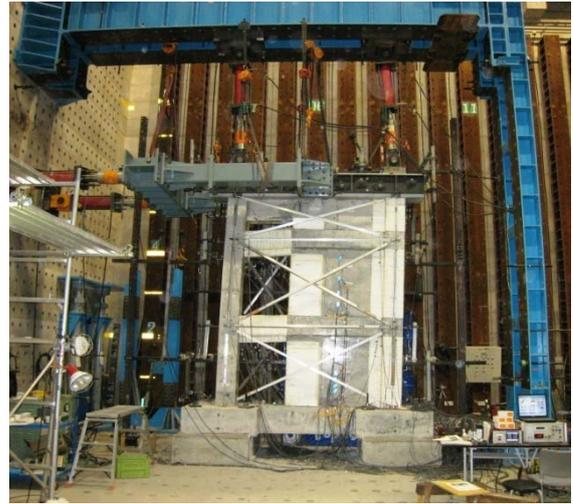
写真一六 偏在開口連層壁繰返し載荷実験<sup>8)</sup>
