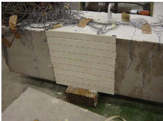
写真一五 鉄筋の欠損部にSRF補強した梁の実験<sup>7)</sup>
