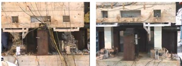
写真—8 RC 建物模型の倒壊とその時点の SRF 模型
